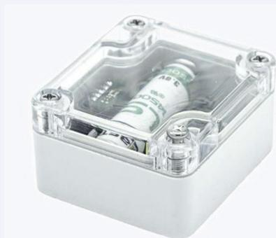
Беспроводной датчик ЭСКОРТ TL-BLE измеряет температуру окружающей среды и освещенность, преобразуя и передавая полученные данные по интерфейсу Bluetooth Low Energy (BLE).
